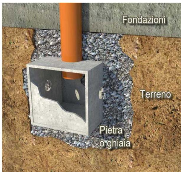
*Dettaglio del pozzetto di estrazione radon con il sistema di drenaggio circostante costituito da pietra o ghiaia*
