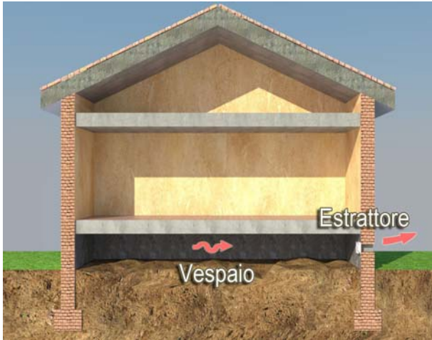
Schema dell'intervento di ventilazione forzata del vespai.
